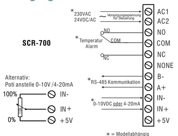
**Bitte beachten:** Der SCR-700 ist nur kompatibel mit symmetrischen und ohmschen Lasten (min. 0,5A Laststrom), induktive Lasten sind nur bedingt geeignet!
