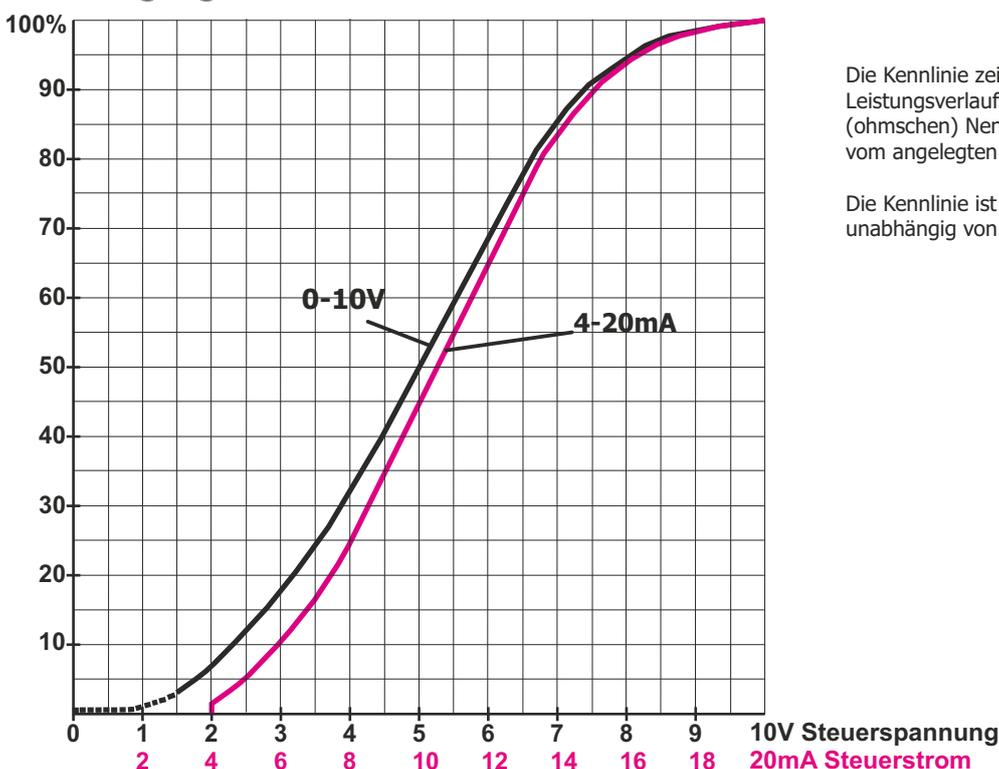
Die Kennlinie zeigt den prozentualen Leistungsverlauf der angeschlossenen (ohmschen) Nennlast in Abhängigkeit vom angelegten DC-Steuersignal
